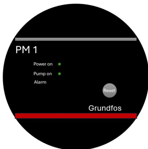
Die Anzeige „Alarm“ leuchtet rot, meist wenn die Pumpe und das Druckrelais luftgesperrt sind. In diesem Fall schrauben Sie die Kappe an der Pumpe leicht ab und drücken Sie die Taste „Reset“, woraufhin die Pumpe wieder anläuft.
