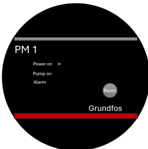
Wenn der Verbraucher den Wasserhahn öffnet, startet die Pumpe (P-04) und die grüne Anzeige „Pump ON“ leuchtet auf.
